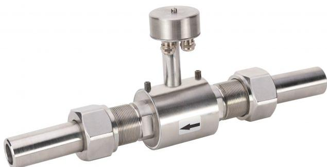
Расходомер электромагнитный РСЦ исполнение на высокое давление, предназначен для непрерывного измерения расхода и суммарного объема протекающей по трубопроводу электропроводящей невзрывоопасной жидкости с удельной проводимостью не менее 200 мкСм/м, находящейся под давлением до 16 Мпа (160 атм). Задать вопрос
