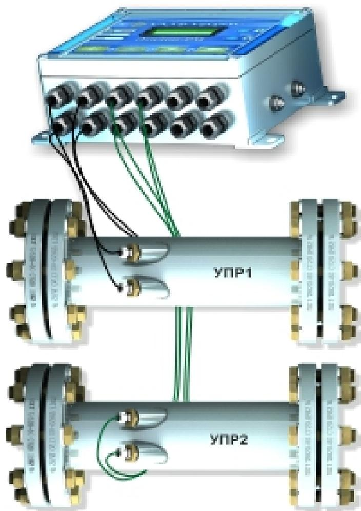
2-канальная версия 2-х лучевого расходомера Эталон-PM 2K2Л 500 мм. Расходомеры-счетчики жидкости ультразвуковые многолучевые Эталон-PM (далее по тексту ультразвуковые расходомеры) предназначены для измерения расхода и объема различных жидкостей с содержанием твердых и газообразных веществ не более 3 % от объема, максимальной скоростью потока не более 12 м/с, числом Рейнольдса не ниже  $Re$  4000, давлением до...
