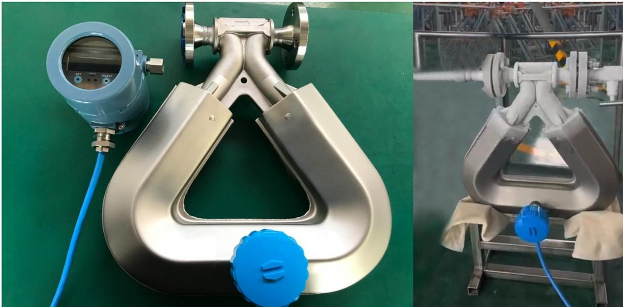
На видео показано, как кориолисовый расходомер-счетчик массовый Streamlux MassFlow T10 проверяется в реальных условиях работы с жидким азотом при температуре  $-200^{\circ}\text{C}$  перед установкой на технологическую линию.
