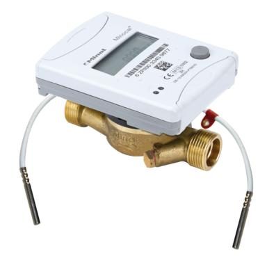
ТЕПЛОСЧЕТЧИК: MINOCAL ISF (C5-ISF), DN 20, QN 2,5, L 130 MM, ДЛИНА КАБЕЛЯ 1,5 M, ДЛЯ УСТАНОВКИ НА ПОДАЮЩИЙ ТРУБОПРОВОД + 2 КРАНА ШАРОВЫХ С ГНЕЗДОМ ТЕРМОСОПРОТИВЛЕНИЯ, DN 20, R 3/4" + УЗЕЛ ПРИСОЕД. (2 ШТУЦЕРА, 2 ГАЙКИ, 2 ПРОКЛАДКИ), DN 20 (G1"B R3/4"), БЕЛАРУСЬ
