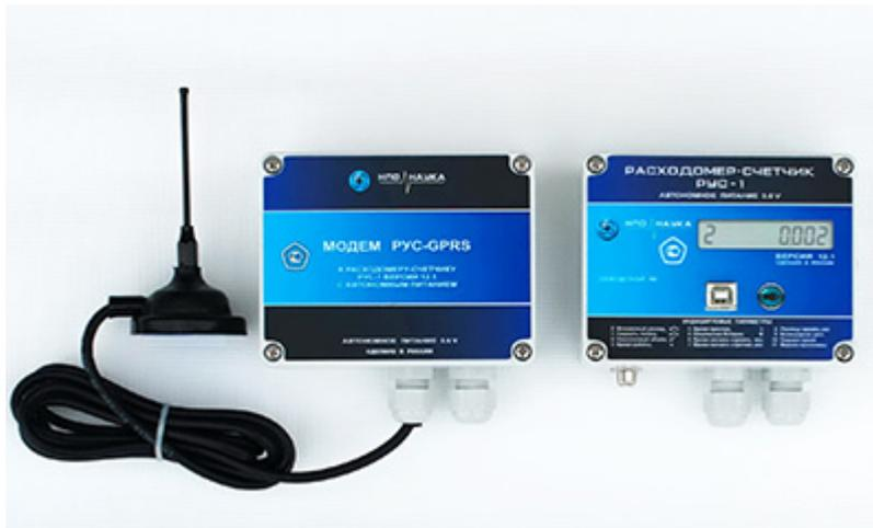
К обновленной версии расходомера РУС-1А теперь можно заказать и GPRS модем. Оба прибора имеют автономное питание! Комплект расходомера с GPRS модемом "РУС-GPRS" может устанавливаться в удаленных местах, где нет возможности провести сетевое питание к электронным приборам: дачные поселки, удаленные системы водоснабжения и др.
